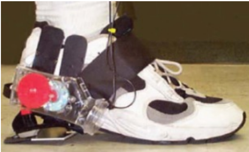
Magnētiskais ģenerators, 250mW (MIT Media Lab)
